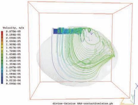
La cuve Divine, de forme elliptique, permet une propagation de la vitesse et donc une recirculation. Grâce à ce mouvement, le vin proche de la paroi est renouvelé et permet un peu plus d'interaction avec l'oxygène.
